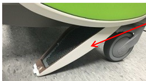
Figur 69: Tilgang til nedre luffilter
