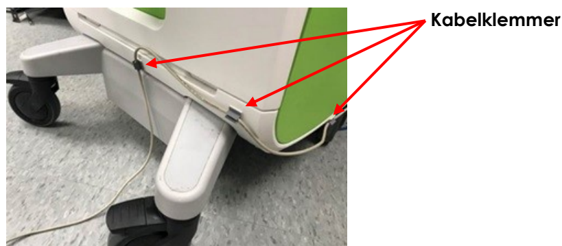
Figur 4: Håndtering av fotpedalkabelen
