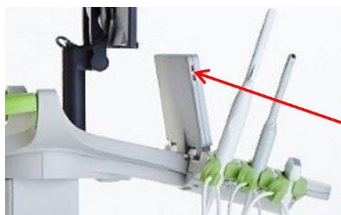
Figur 7: USB-kontakter på venstre side av berøringsskjermen
