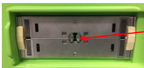
Figur 20: Låsehakk på probetilkoblingssporet
