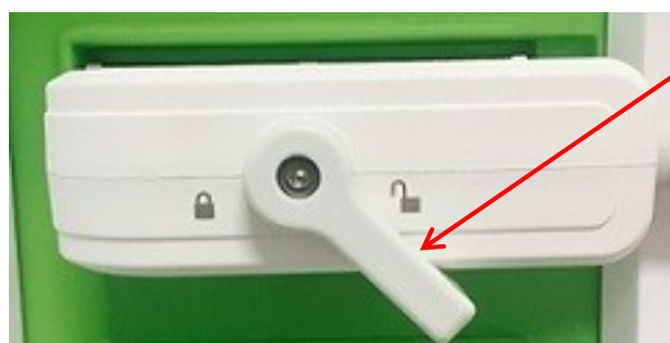
Figur 30: Låseknott for probetilkobling i ulåst posisjon
